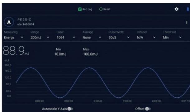
▶ エネルギーのライングラフ表示では、ユーザーは時間の経過とともにレーザーの変化を追従できます。
