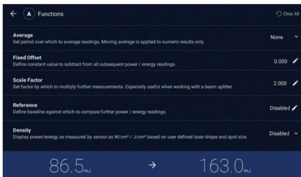
ユーザーが定義した関数を追加し測定に適用することができます。例：測定値にユーザーが定義した係数を乗算したり、比較する基準値を定義するなど。
