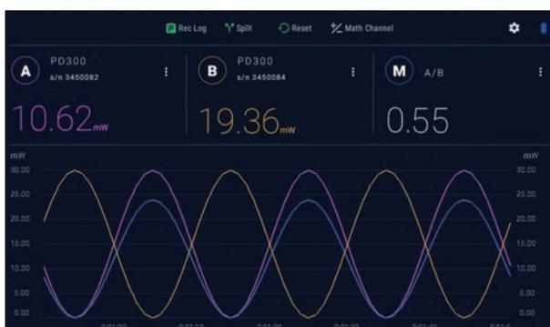
ディスプレイ上部の [Merge] と [Math Channel] の両方をタップすると、3つの測定値全てが1つのライングラフスクリーンに表示されます。[Math Channel]を再びタップすると2チャンネル表示となり、[Split] をタップすると各チャンネル表示に戻ります。
