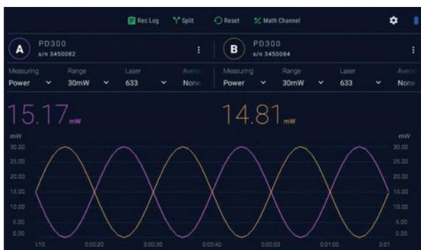
ディスプレイ上部の [Merge] をタップすると、視覚的に比較しやすいように、2つのチャンネルの測定値が1つのライングラフスクリーンに重なります。
