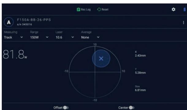
▶ ビームトラックセンサー接続時には、パワー測定の外、ビーム位置、ビーム径を表示します。
