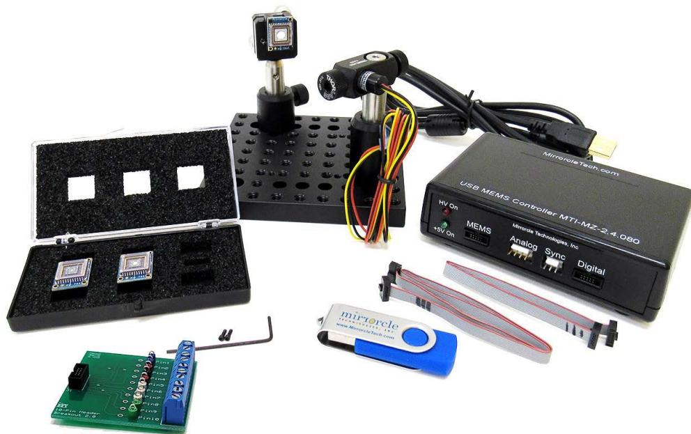
図1. Mirrorcle MEMS開発キット（DK-015 Standard Dev Kit）構成例
