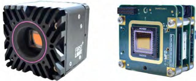
図8：C-RED 3カメラのSTD型(左)とOEM型(右)
