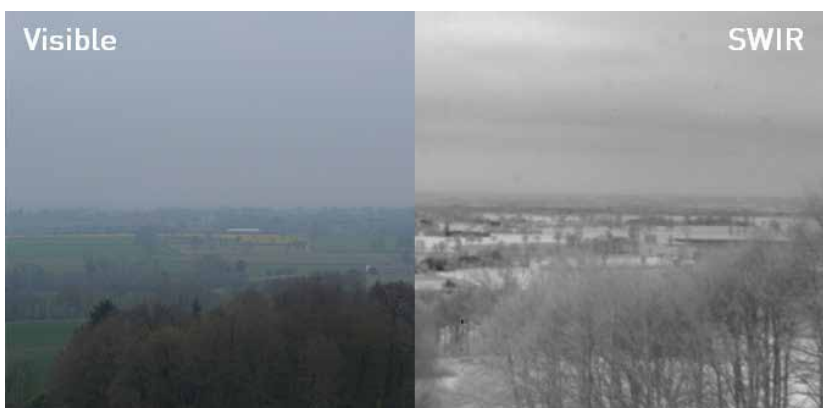
図2: 霧の中の風景を可視光領域カメラと短波長赤外領域カメラで撮影した画像。SWIRでは、景色が鮮明に写り、約10km先まで見通すことができます。Nikon D5200カメラ(左)とC-RED 3カメラ(右)で撮影。
