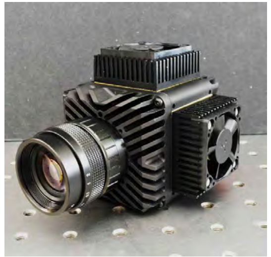
外付けファンとヒートシンクの構成例
