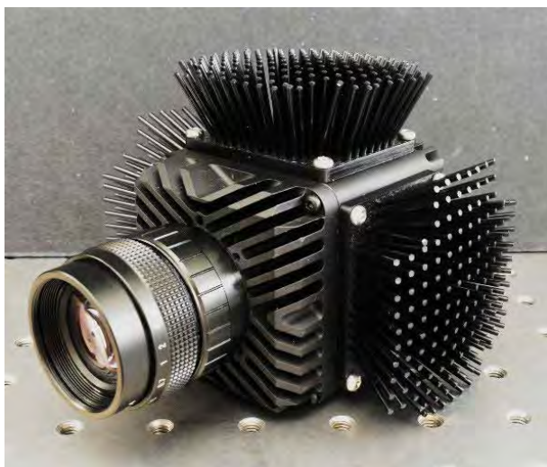
パッシブヒートシンクの取付図
