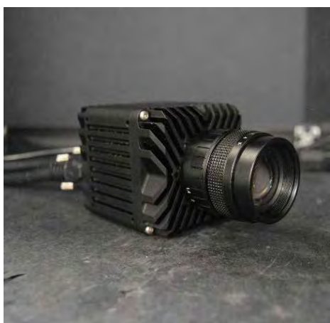
レンズを取り付け、熱交換を行う表面を増やした構成例
