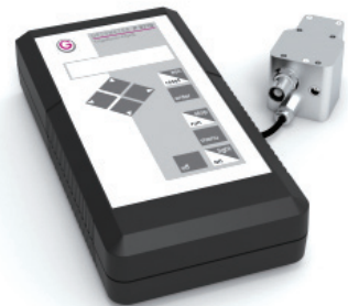
図1: シングルチャンネルオプトメータ P-9710-2 を備えたISD-1.6-SP-V02 検出器
