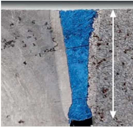
OCTを使用することで、溶接プロセス中に直接、溶接深さを特定することができます。 (出典：Lessmüller Lasertechnik GmbH)
