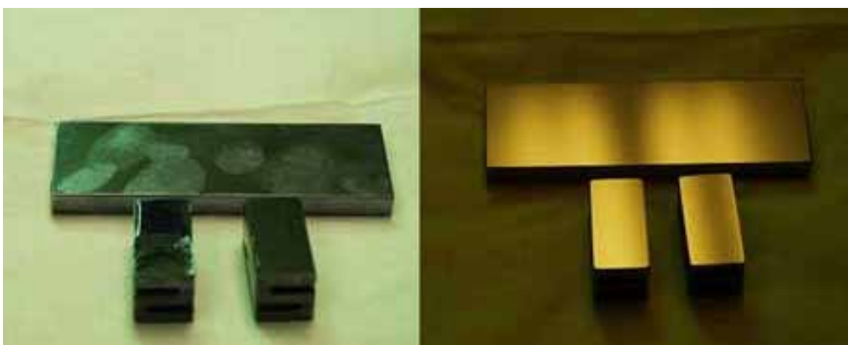
X線オプティクスのブロックワックをファースト コンタクト™ でクリーニングした時の比較写真。左：使用前、右：使用后。
