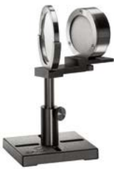
ビームスプリッタ (スプリッタ未装着時) ダイレクトビームがセンサに入射
