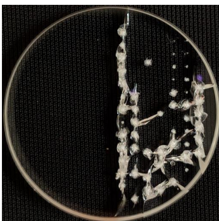
図 4 損傷しきい値試験後の損傷したガラスウェッジ。この UVFS ガラスウェッジは、当社の偏波保持型ビームサンプラー（PPBS-UVFS）に使用されています。
